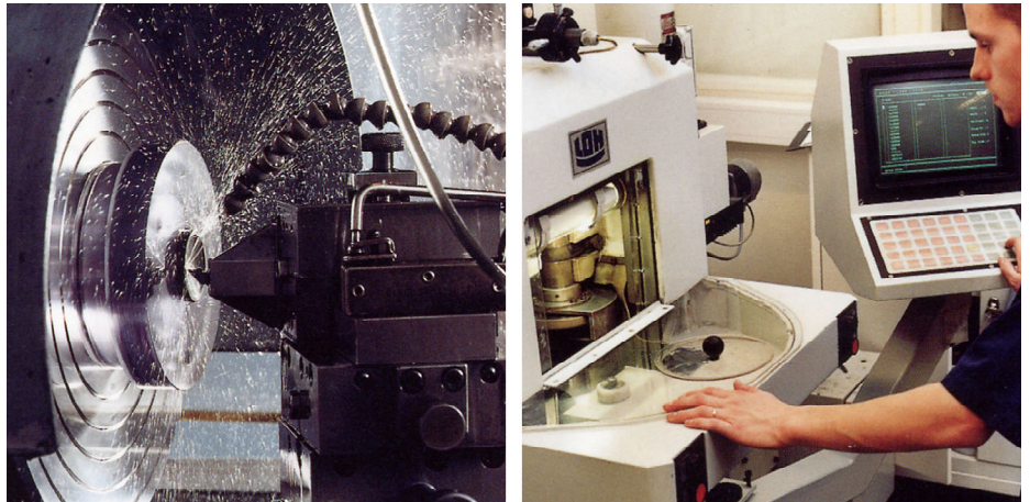
Figura 13.4 IZQUIERDA: máquina de procesamiento de diamantes; DERECHA: pulimentado de lentes
