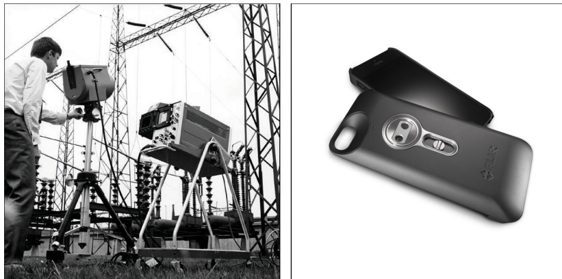
Figura 13.2 IZQUIERDA: Thermovision modelo 661 de 1969. La cámara pesaba unos 25 kg, el osciloscopio 20 kg y el trípode 15 kg. El usuario también necesitaba un generador de 220 VCA y un recipiente de 10 litros con nitrógeno líquido. A la izquierda del osciloscopio se puede observar el accesorio Polaroid (6 kg). DERECHA: FLIR One, que se ha lanzado en enero de 2014, es un accesorio acoplable que permite a los iPhone tener funciones de imágenes térmicas. Peso: 90 g.
