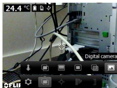
Para visualizar correctamente una imagen de fusión (modos *MSX*, *Picture-in-picture* y *Fusión térmica*), la cámara debe realizar ajustes para compensar la pequeña diferencia de posición entre la lente de la cámara y la de infrarrojos. Para ajustar la imagen con precisión, la cámara necesita obtener la distancia de alineación (la distancia hasta el objeto).
