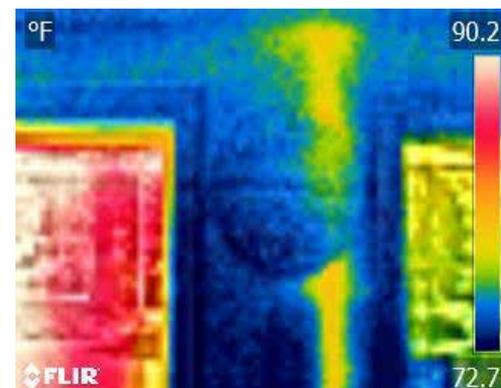
Tubo de drenaje caliente en la pared
