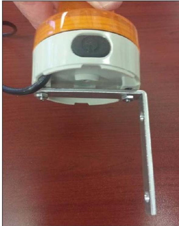
Vuelva a montar el soporte en la luz, deslizando los tornillos debajo de la ranura como antes. Si el soporte está suelto, quite y apriete los tornillos con otro  $\frac{1}{4}$  de vuelta.
