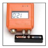
Nota: Cuando revise modelos digitales del medidor de madera con el MCS-1, el medidor deberá ser ajustado como predeterminado: 4-pin, 70 °F, abeto Douglas para obtener los 12% y 22% de lecturas nominales. Si se ajusta en 2-pin, 70 °F, abeto Douglas, las lecturas serán 12.7% y 23.6%.
